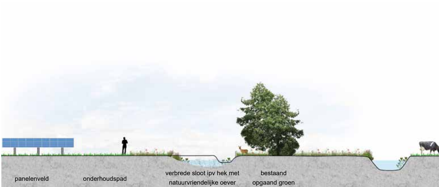
Afbeelding 23. Dwarsprofiel oostkant (de zwarte lijn is het huidige maaiveld)
