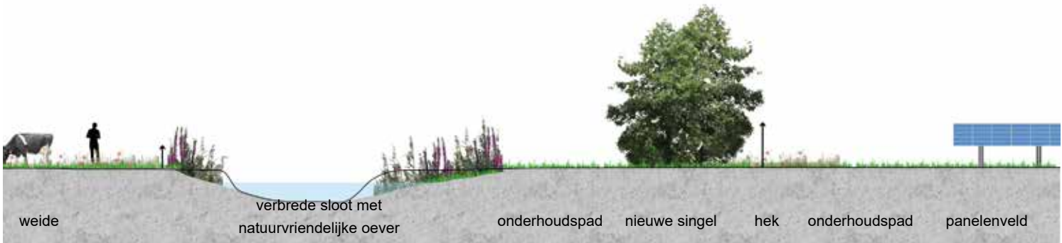
Afbeelding 22. Dwarsprofiel westkant (de zwarte lijn is het huidige maaiveld)
